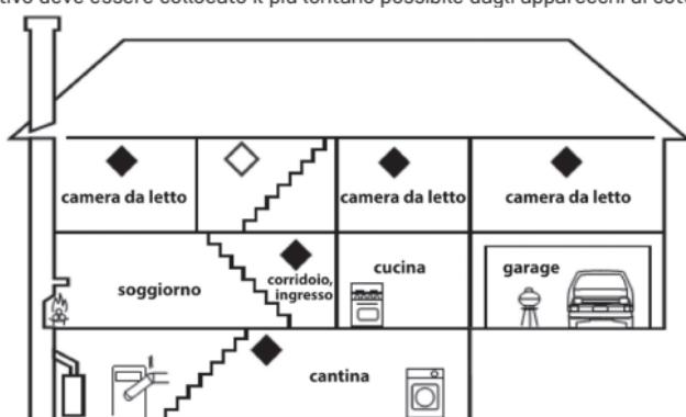
◆ Collocazione conforme ai requisiti dell'NFPA (National Fire Protection Association of the USA)
